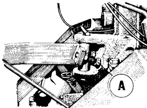
Omezovací šrouby na závěsu válce "A" seřídte tak, aby při max. otočení klečemi doprava nebo doleva (až na doraz) válec nenarážel na pneumatiky malotraktoru.
