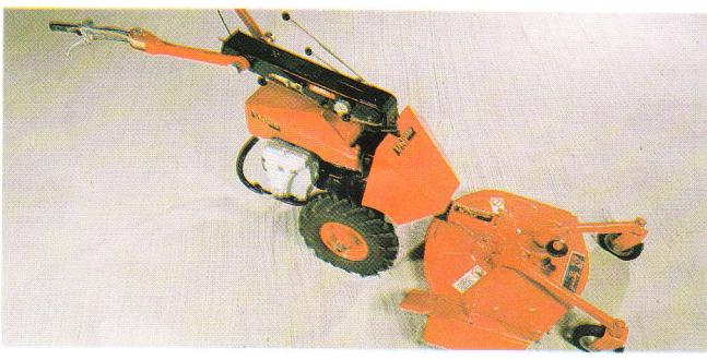
ve spojení s jednonápravovým malotraktorem MT7-033 je určen k sečení travních ploch v parcích, zahradách, hráziach apod. Pracovním orgánem žacího stroje je rotující lišta — nůž se dvěma ostrými na nábežných stranách. Nůž rotuje ve válcovém krytu s tangenciálním vývodem sečeň hmoty s usměrňovacím štítkem. Výška řezu je dána polohou nože vůči stroji a podpěrným kolečkám, dá se plynule regulaovat. Pretížení prevodů chrání tři spojky.
