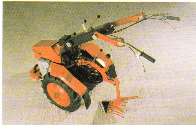
Vyorávač brambor AVB-301 ve spojení s malotraktorem MT7-032 může pracovat ve všech druzích půd se sklonem do 7°. Podmínkou jsou odstraněné natě z brambor.
