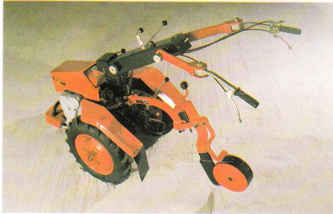
Vyorávač kořenové zeleniny AVZ-311 ve spojení s malotraktorem MT7-032 vyorává kořenovou zeleninu, která se pak za natě vytahá, očistí a uloží.
