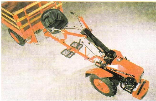
tažený malotraktorem MT7-032 nebo MT7-033 slouží k přepravě nářadí systému UNI, sypkých materiálů, palet s ovocem či zeleninou, plodin a dalších hmot a materiálů. S nástavbou pak pro přepravu objemových materiálů jako sena, slámy, trávy apod. Návěsy ANV 367 a ANV 368 se od sebe liší v sedačkách řidiče (u ANV 367 jednoduchá, u ANV 368 komfortní lepe odpružená, navíc doplněná plátěnou stříškou). Návěsy jsou kovové konstrukce s brzdou, osvětlením napájeným baterií dobíjenou generátorem malotraktu.
