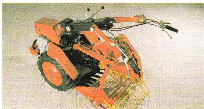
ve spojení s malotraktorem MT7-032 slouží k vyorávání brambor na pozemcích s předem odstraněnými natěmi. Spolehlivě pracuje na svazích s příčným sklonem do 7° na všech druzích půd s kameny do Ø 6 cm. Vyorača vyore brambory z jednoho rádku, očistí je od zeminy a uloží na její povrch. Vyoračací rádlice se dá nastavit do dvou poloh. Její zahľoubení je plněně nastavitelné šroubem. Vytřásací rošt má možnost usměrňovat brambory do hrubku v ose rádku nebo do dalších dvou poloh vpravo.
