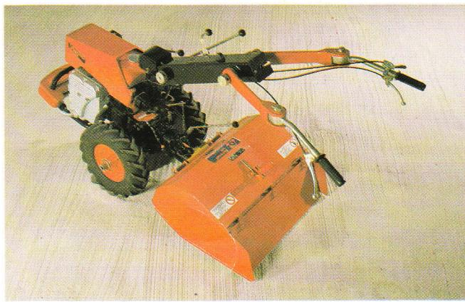
(úhlové nože) o záběru 66 cm se používá ve spojení s malotraktorem MT7-033 pro běžné plošné i meziřádkové kultivační práce s jemným drobením půdy.
