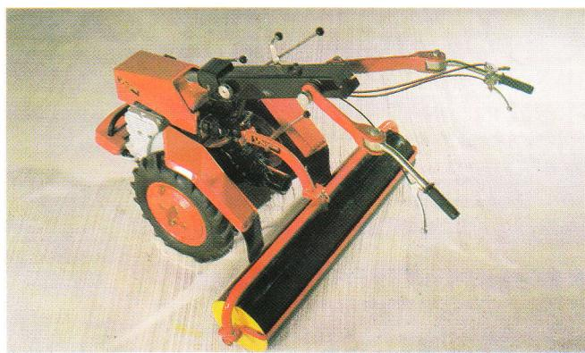
Válec AVA 321 ve spojení s malotraktorem MT7-032 slouží k utužení vrstvy půdy po zemku, hřiště, cest apod. Naplněním vodou se zvýší přítlač.
